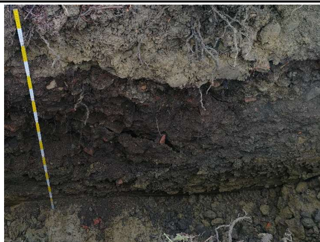
Foto 4 – Nucleo di rottami misti a terreno scuro sino a 1,8 m dal p.c. (S15).
